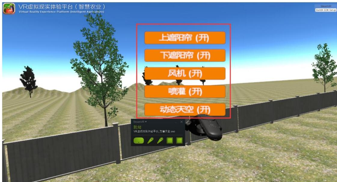
9、按住手柄的定位组合键不放，再选择虚拟空间菜单项中需控制的按钮，当选择项变成黄色后，然后再按下扳机键，可实现对虚拟空间中菜单项的控制按钮的控制，并实现虚拟环境中对应设备的开与关的动态效果，手柄与菜单项显示如下：
