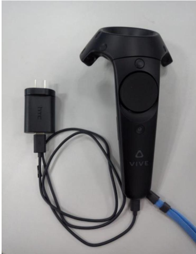
手柄按下“系统键”后，开启，手柄上的指示灯显示蓝色，当与两个定位器信号接通，且接入虚拟运行平台后，指示灯会变成绿色，用户就可通过手柄进行虚拟环境中按键操作，如下：
